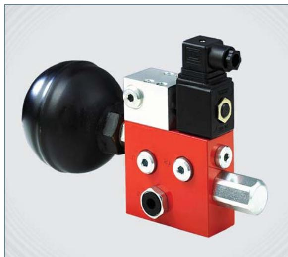
SUH valfi direk olarak ana hidrolik devreye bağlanır (350 bar'a kadar olan tiplerde) ve HPVL pilot valfe düşük basınçta hidrolik sağlar. (normalde < 50 bar)
