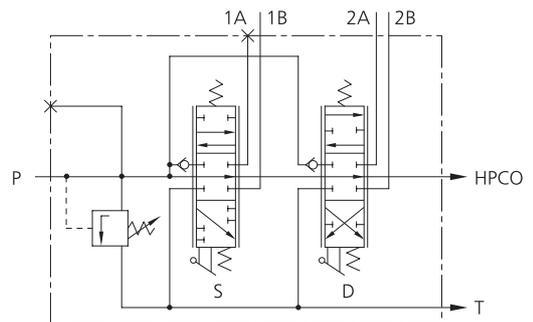
Orta-giriş gövdeleri, iki ayrı valf setini bir valf paketinde birleştirmek için kullanılır. Farklı pompalar valf setlerinin akış-aşağısı ve akış-yukarısına debi sağlarlar ve sağlanan debiler ayrı kullanılabilir ya da akış aşağısı valfi için birleştirilebilir. Akış aşağısı valf seti için opsiyonel emniyet valfleri mevcuttur. Üçüncü tip ise boşaltma valfli olanlardır.
