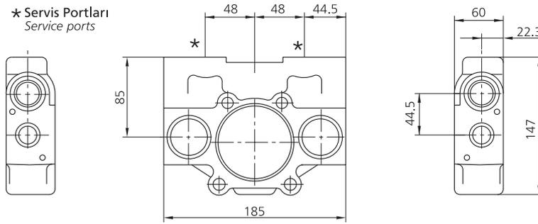
Valf dilimleri, normalde antişok veya anti-kavitasyon valfleri için gerekli işlemler yapılmadan gönderilir. Antişok ve anti-kavitasyon valfli olarak istenen valflerde, dilimlerin A ve B portları için her iki tarafı da işlenir.
